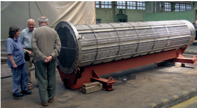
A Paksi Atomerőmű részére készülő technológiai kondenzátor nyomáspróbára való felkészítés előtt.
