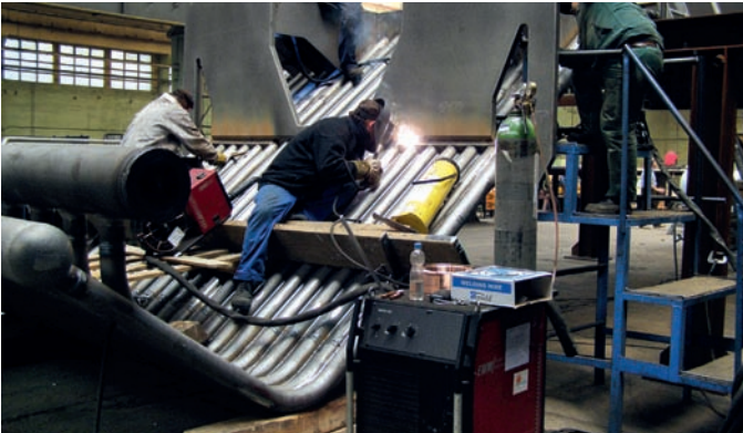
Az osztrák Bertsch GmbH részére készülő biomassza tüzelésű kazán fala előgyártás alatt.
