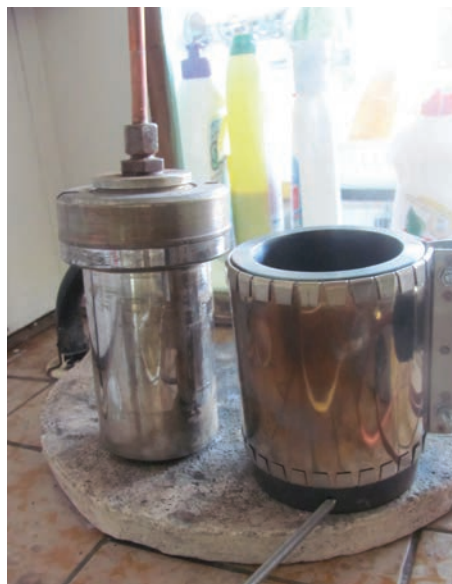
7. ábra. A szintézisreaktor és a hozzá tartozó köpenyfűtő egység
