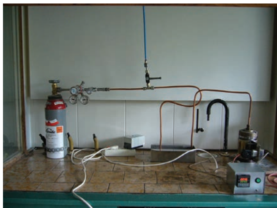
6. ábra. Félüzemi Fischer-Tropsch alkoholszintézis megvalósítására alkalmas kísérleti berendezés
