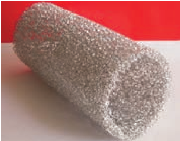
3. ábra. Alumíniumhabból készült csatorna
