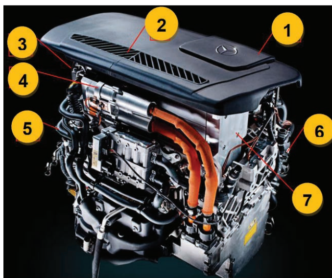
10. ábra. A H 2 üzemanyagcellás erőforrás részei [1-Vezérlő elektronika, 2 - Levegő bevezetés szűrő, 3 - Hidrogén nyomásvezérlő, érzékelő, 4 - A kiadott villamos energia vezérlése, 5 - Turbóvezérlő a levegőhöz, 6 - Párasított levegő bevezetése, 7 - Üzemanyag cella blokk]
