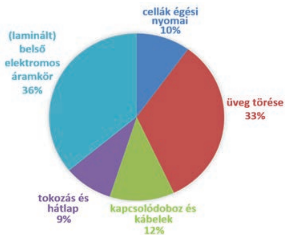
4. ábra. A terepen 8 évig telepített 21 gyártó különböző napelemes moduljainak vizsgálati eredményei 5
