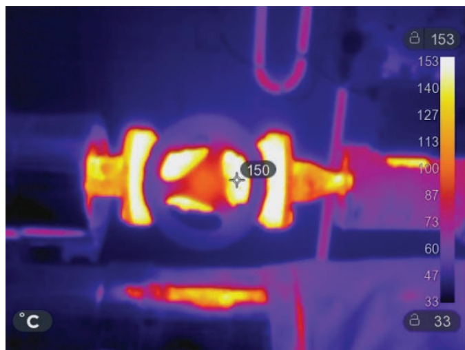
2. ábra. A DN 50 elzáró szelep termovíziós képe
