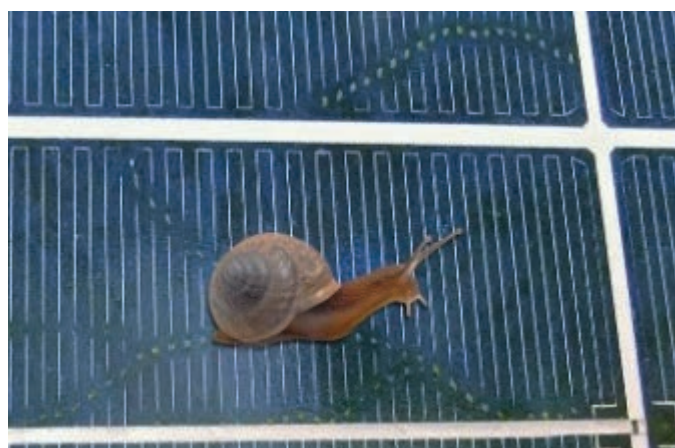
2. kép. A csiganyomok tipikusan az ezüst paszta elszíneződésének a hibája
