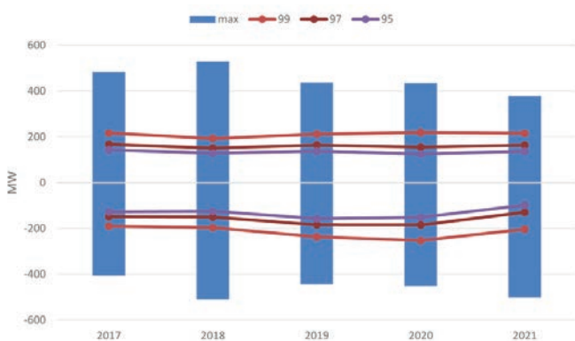
5. ábra. A hazai aFRR aktiválások szélsőértékei, percentilisek ([9] alapján saját számítás)
