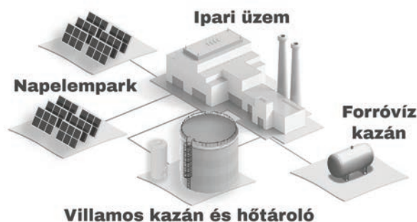
2. ábra. Tervezett hőtároló rendszer sematikus ábrázolása
