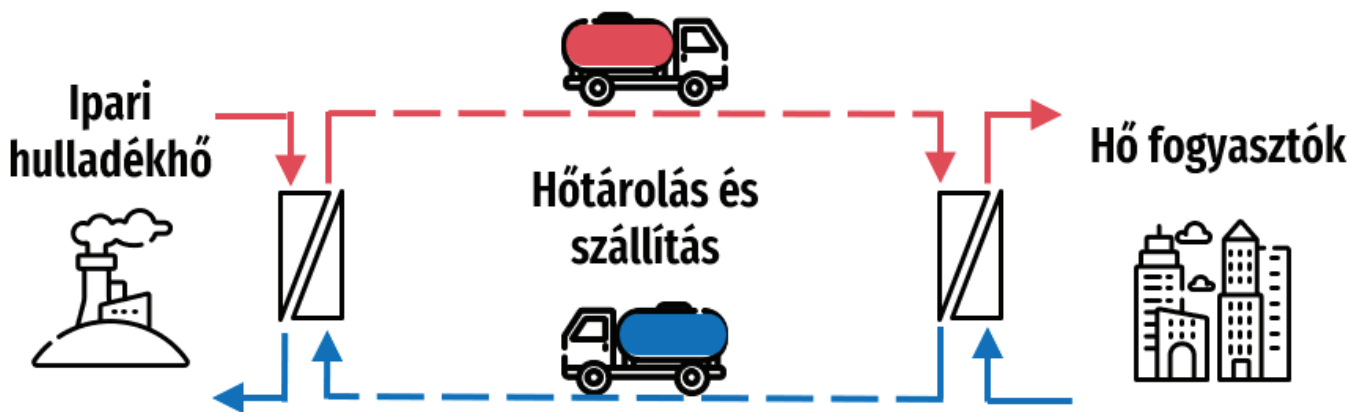
2. ábra. A mobil tárolós hőellátás felépítése
